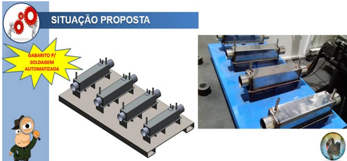
Figura 12 – Situação proposta da base para solda
